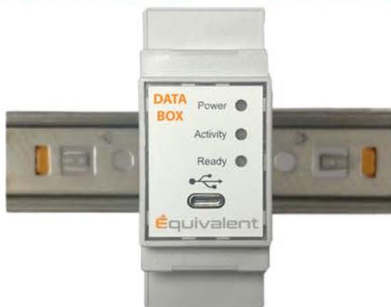
Module installer sur rail DIN
